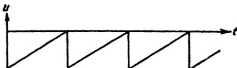
Bild 46. Der Zeit proportionaler periodischer Spannungsanstieg.
