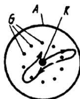
Bild 49. Flugbahn der Elektronen in einer zylinderförmigen Röhre.
