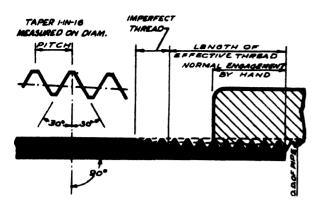
Fig. 174--AMERICAN STANDARD PIPE THREAD
