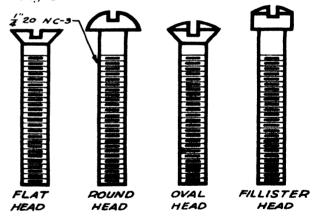
Fig. 168—MACHINE SCREWS
