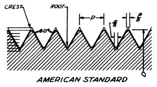
Fig. 159—THE AMERICAN STANDARD THREAD IS V-SHAPED.
