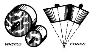
Fig. 199—FRICTION WHEELS
