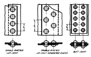
Fig. 178—RIVETED JOINTS
