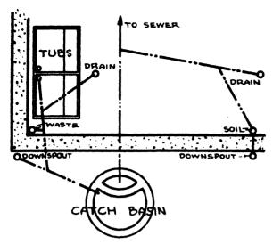
Fig. 251—SEWER LAYOUT FOR HOUSE
