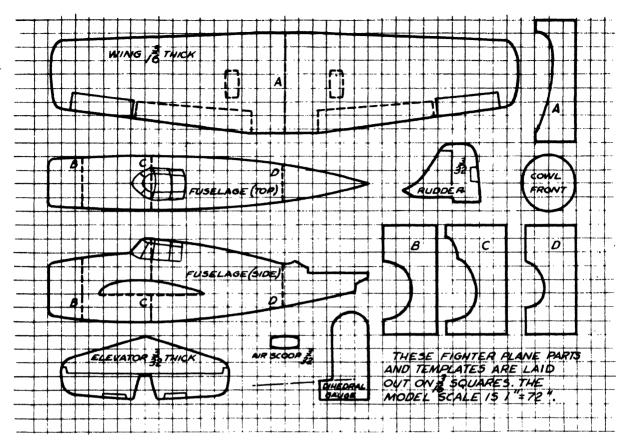
Fig. 223—TEMPLATE DRAWINGS FOR A MODEL PLANE
