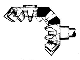
Fig.~202—A BEVEL GEAR
