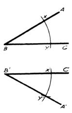
Fig. 103—TRANSFERRING AN ANGLE
