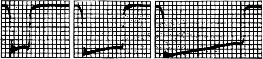
(d) 0.5 \mu\text{sec} . (e) 1 \mu\text{sec} . (f) 2 \mu\text{sec} . Magnetron current pulses of average amplitude = 10 amp.
