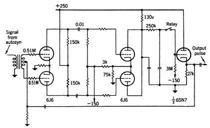
Fig. 7-9. - Azimuth mark circuit.
