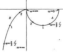
Fig. 14.8.—Servo motor transfer loci.
