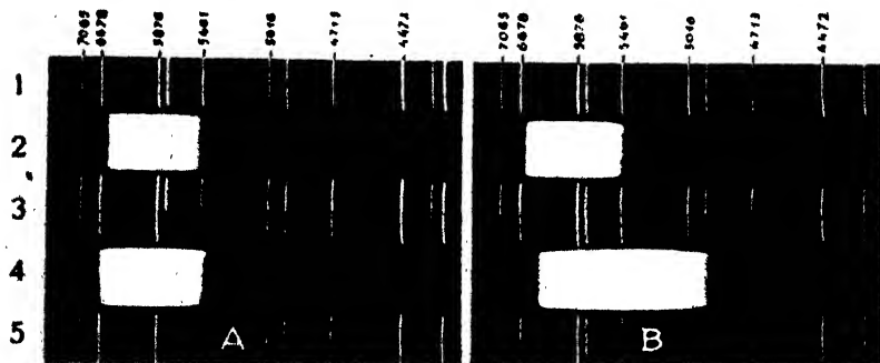
Fig. 12. Fluorescence de la Flavine synthétique: A, no. 2, cristaux à +18^{\circ} , no. 4, cristaux refroidis dans l'air liquide; B, no. 2, solution aqueuse congelée et refroidie dans l'air liquide; no. 1, même solution à +18^{\circ} .
