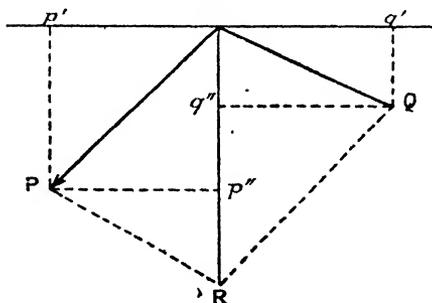
tante, et  $OQ$  par  $Oq'$  et  $Oq''$ . Il résulte des propriétés géométriques évidentes de la figure que  $Op'$  et  $Oq'$  se détruisent et que  $Op''$  et  $Oq''$  ont pour résultante  $OR$  ce qui établit le résultat annoncé.
