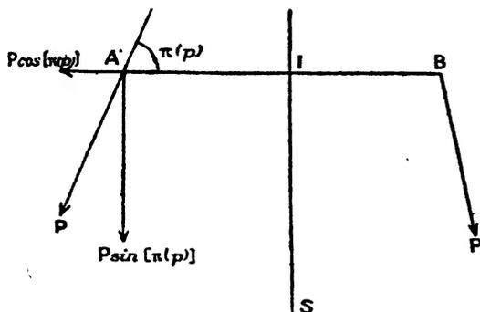
Remplaçons AP par les deux forces :  $P \cos[\pi(\rho)]$  dirigée suivant IA et  $P \sin[\pi(\rho)]$  dirigée suivant la perpendiculaire en A à AB; faisons de même pour BP.
