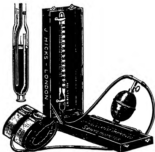
FIG. 95.—THE ARMET SPHYGMOMETER. (Leonard Hill.)
