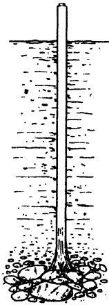
FIG. 210.—“Broomed” Timber Pile.
