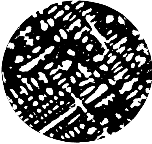
A. Copper 50, nickel 50 %. \times 86
