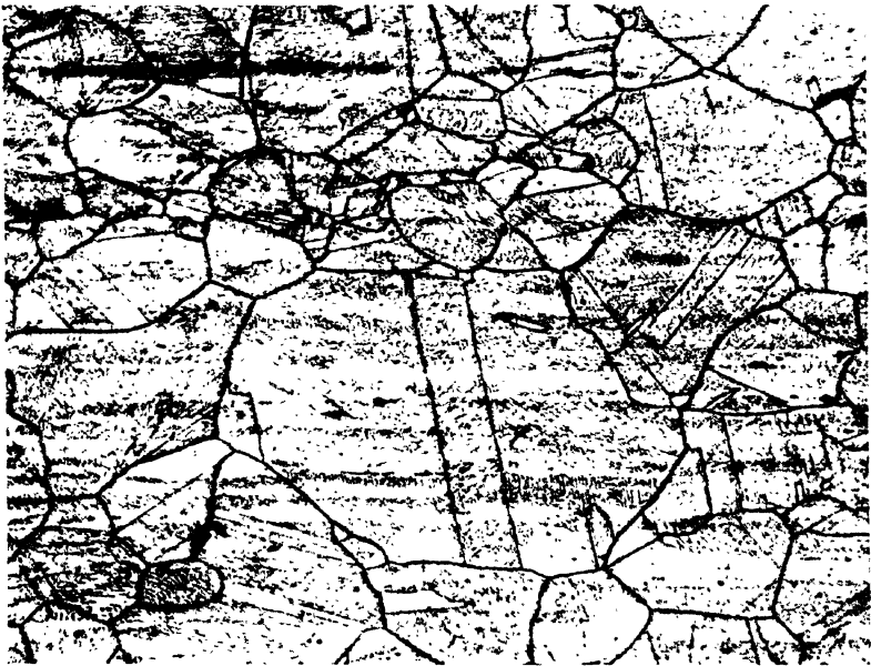
B. "Stainless" steel, 18 % Cr. 8 % Ni. \times 150
