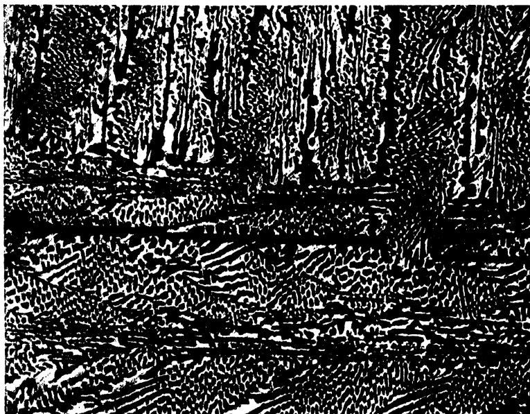
A. Eutectic of white pig iron. \times 200
