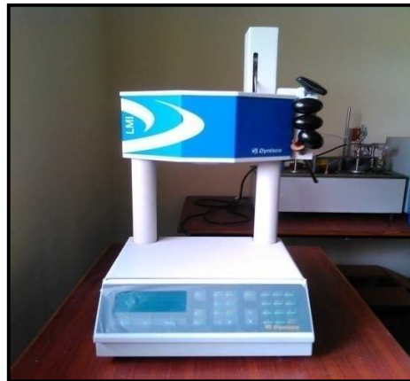
Fig 3.4 Dynisco melt flow indexer
