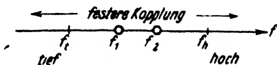
Bild 27. Zusammenhang zwischen den Eigenfrequenzen f_1 und f_2 und den Koppelfrequenzen f_t und f_h .
