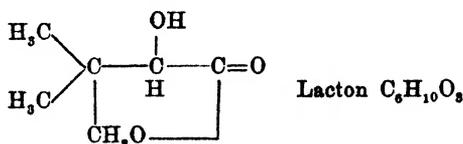
Der Abbau dieses Lactons bestätigte die Zusammensetzung als  $\alpha$ -Oxy- $\beta$ , $\beta$ -dimethyl- $\gamma$ -butyrolacton. Der Körper konnte synthetisch hergestellt werden. Kondensation des Lactons mit  $\beta$ -Alanin gab Pantothensäure, die somit synthetisch zugänglich ist. Die Formel der Pantothensäure ist folgende:
